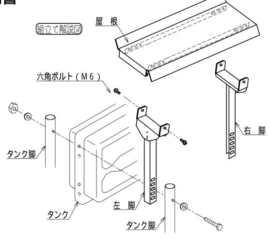
タンク脚を固定する六角ボルトで左右の脚を図の様に固定します。 左/右脚は正面から見て垂直になるよう固定してください。 屋根を脚の上に乗せ、屋根裏面のミゾの内側に左右脚をはめこみます。 屋根裏面のミゾの長孔部で左/右脚を付属のボルト(4本)で固定してください。 タンク脚および屋根裏面のボルトの締め付けにゆるみがないことを確認してください。
